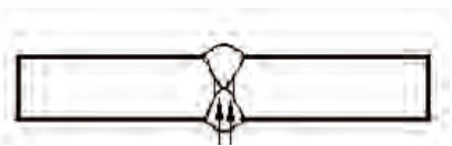
نفوذ ناقص در اتصالات شیاری دو طرفه
