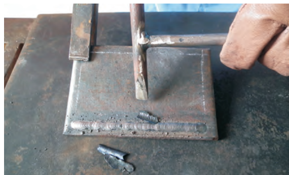
زاویه‌ی الکتروود در جهت پیشروی
